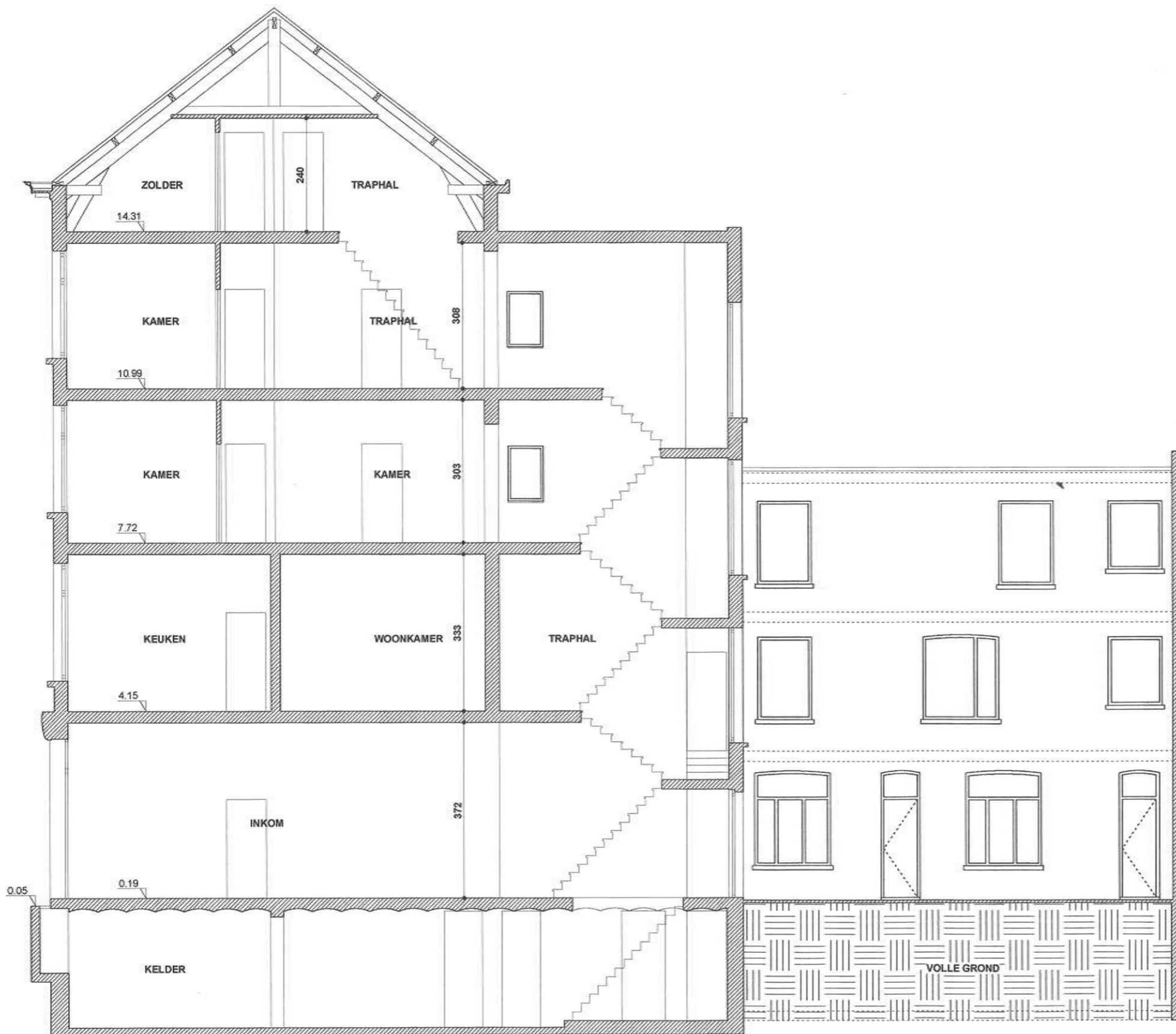
BESTAANDE TOESTAND DOORSNEDE A - A 1/100
